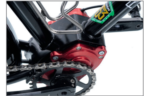
Die eigens angefertigte Edelstahlbrücke hält das Pinion-Getriebe
