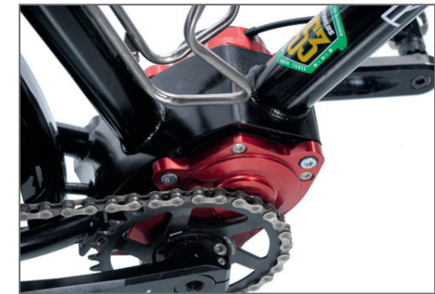
Die eigens angefertigte Edelstahlbrücke hält das Pinion-Getriebe
